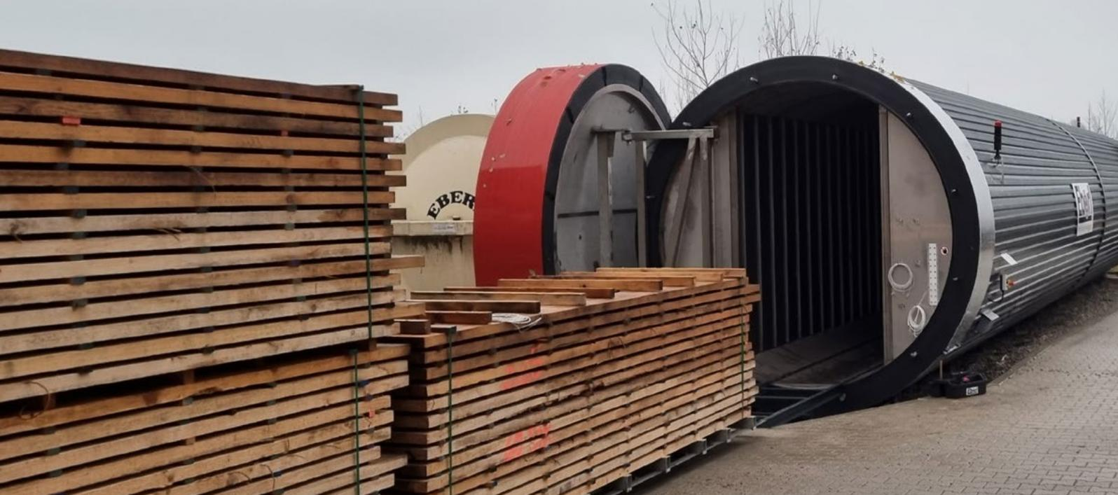
Dans un processus d'étuvage à vapeur classique, les résineux nécessitent des durées d'étuvage très longues, généralement trois semaines, pour obtenir une teinte de vieux bois ou une coloration foncée. En outre, des installations spéciales et coûteuses en chauffage sont nécessaires pour générer de la vapeur. Après un processus d'étuvage classique, le bois doit être remanutentionné puis empilé sur lattes avant d'être rechargé dans un séchoir.
